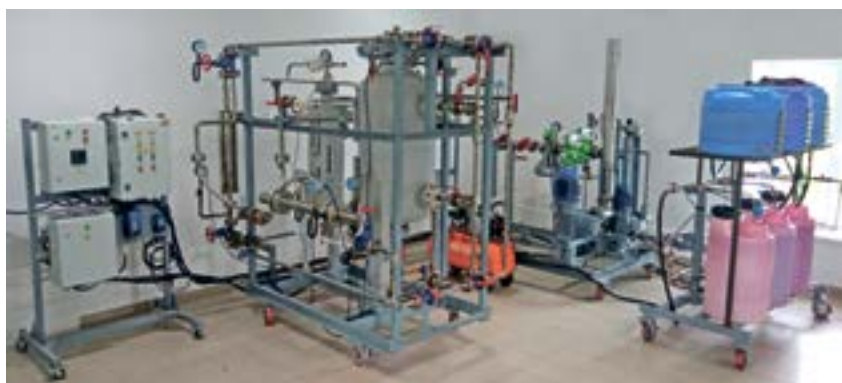
Рис. 2. Установка для стендовых испытаний экспериментальных образцов гидроциклонов Fig. 2. Installation for bench testing of experimental samples of hydrocyclones
